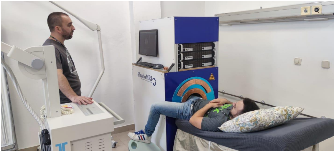
Simulació d'ús del dispositiu IRM, primera màquina de ressonància magnètica portàtil del mercat, desenvolupada per un grup de científics de l'Institut d'Instrumentació per a Imatge Molecular (i3M, CSIC – UPV) i la spin-off del centre PhysioMRI Tech.
