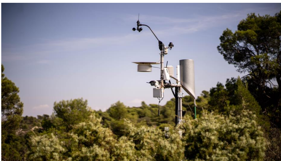
Un anemòmetre permet mesurar la velocitat del vent. Crèdits: CIDE Comunicació.
