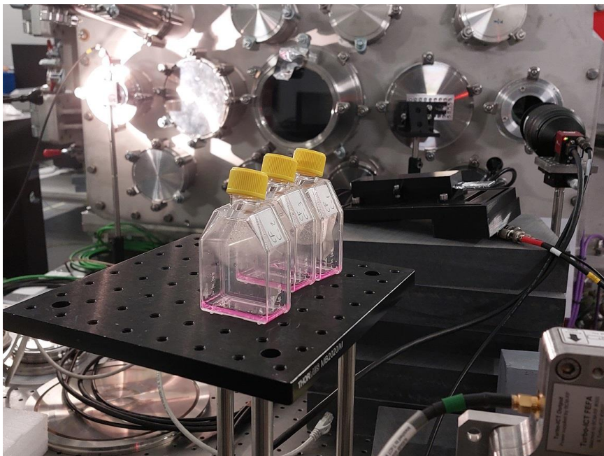
Mostres cel·lulars i sistema de buit del làser VEGA-3.
