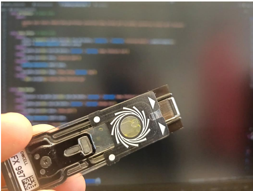
Un flowcell o cambra de flux, element de seqüenciació transcriptòmica de lectures llargues mitjançant Nanoporos, avaluat per l'equip de l'I2SysBio (CSIC - Universitat de València). Crèdits: Pablo Atienza.
